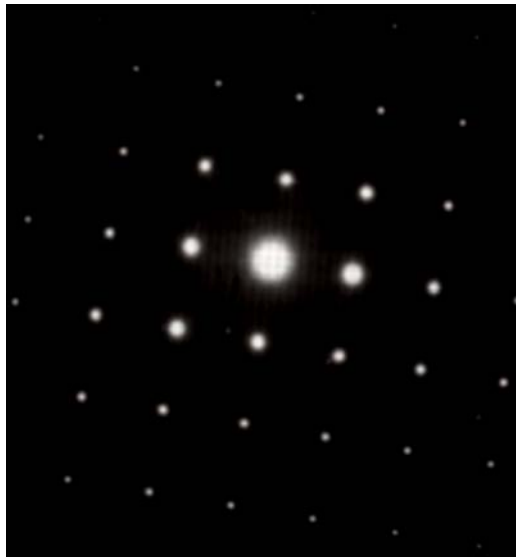
Fig.3. Elektronen-Beugungsbild an einem BiOCl- Kristall
