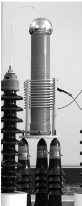
Fig.19. Anordnung von Primär- und Sekundärspule (rechts), ebenfalls abgebildet ist die Sekundärfunkenstrecke, welche durch die terminal angebrachte Konduktorkugel und einen zuführenden Leiter (Aluminium-Rohr mit Messingstift am Ende) gebildet wird; links weitere Sekundärspule
