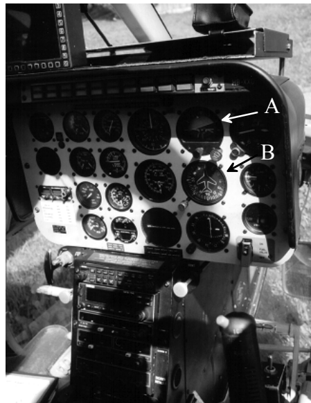
Fig.1. Kreiselinstrumente im Cockpit (Bell Jet Ranger 206B): A künstlicher Horizont ( attitude indicator ), B Kurskreisel / Kreiselkompass ( directional gyro )
