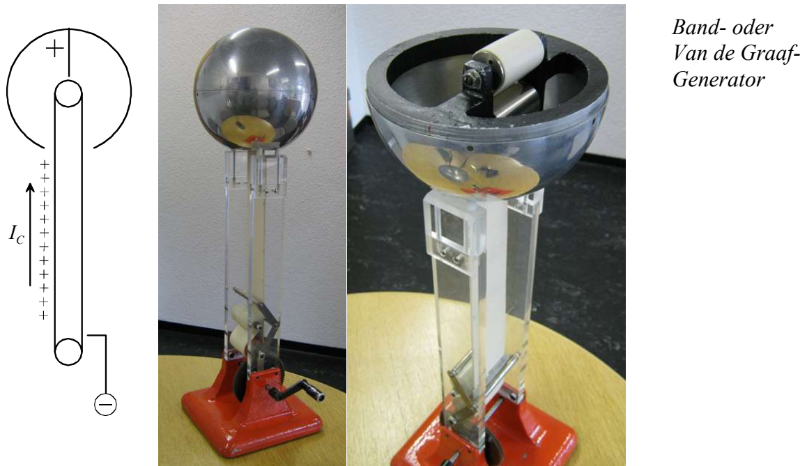
Fig.4. Aufbau eines Van der Graaf – Generators: Durch Reibung oder Aufsprühen fixieren sich auf dem aufwärtslaufenden Band positive elektrische Ladungen. Im inneren der Konduktorkugel (rechts) werden diese Ladungen auf die Kugeloberfläche abgezogen. Die Konduktorkugel dient als Ladungsspeicher (Kondensator).
