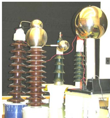
Fig.1. Band-Generator und Konduktorkugeln zur Untersuchung elektrischer Kräfte
