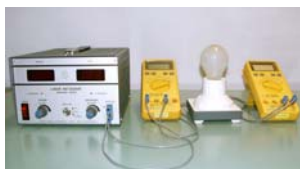
Fig.4. Aufbau zur Bestimmung des Widerstands eines Glühwendels
