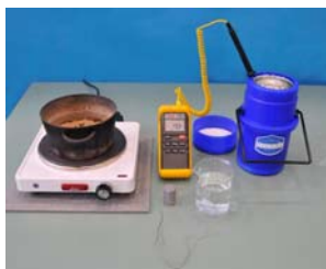
Fig.3. Messaufbau zur Bestimmung der Wärmekapazität
