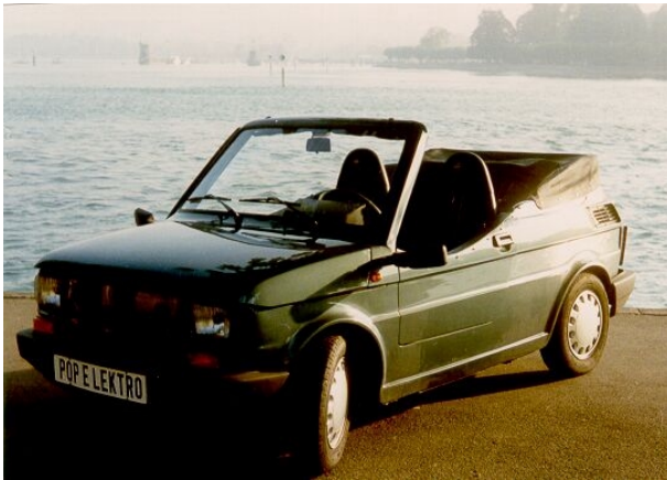
Figure 2: The electrical cabrio fun car POP-E (empty weight 800 kg, 12 kW asynchronous motor - Photo: Ingenierbüro für Solarenergie Konstanz).
