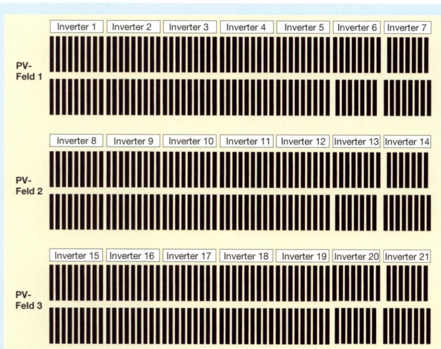
4 Ein vertikaler schwarzer Streifen symbolisiert einen Modulträger, bestehend aus 8 Solarmodulen mit je 230 Wp Nennleistung
